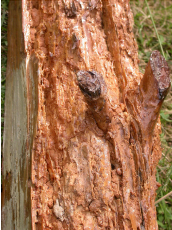
Bild 3 (links): Durch Hausbock verursachte Schäden: Unter einer Papierdünnen Oberflächenschicht ist das Holz stark zerfressen. Äußerlich ist oft wenig erkennbar.
