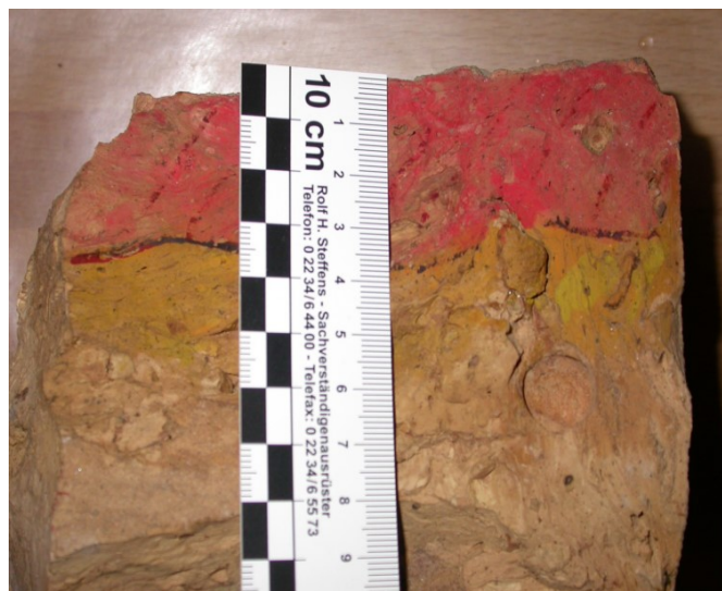
Bild 2: Eindringtiefe in Ziegelstein (mittelalterliches Klosterformat) ebenfalls über 30mm nach 8 wöchiger Lagerung in belüftetem Raum. Oberflächenauftrag 1Liter/m 2 . Lagerung
