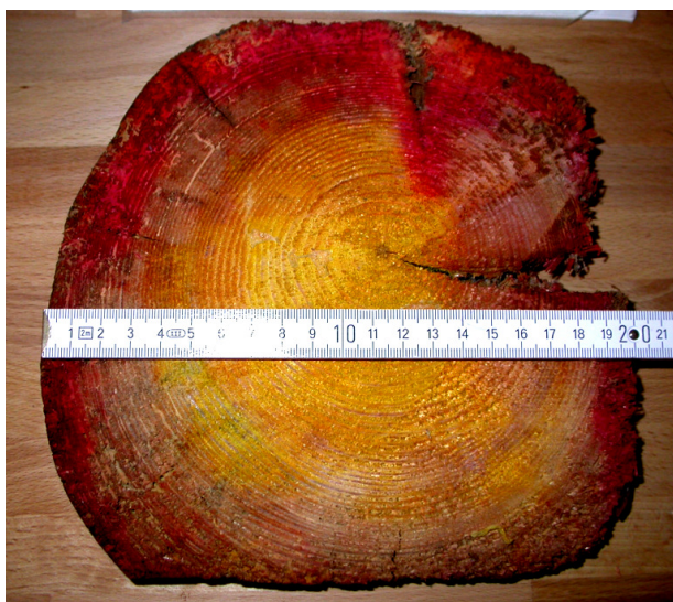
Bild 1: Eindringtiefe über 30mm bei oberflächlicher Aufbringung durch Streichen (2 Anstriche, 300ml/m 2 , Holzfeuchte 12-18%) nach 5 Monaten im Objekt. Bor durch Curcumin-Reagenz rot angefärbt
